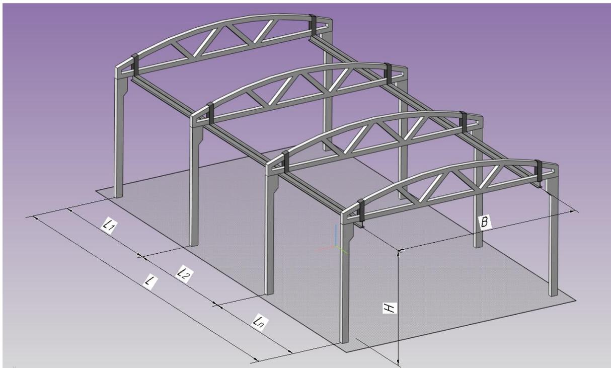
**B** – пролет кранового пути (расстояние между осями рельсов);
